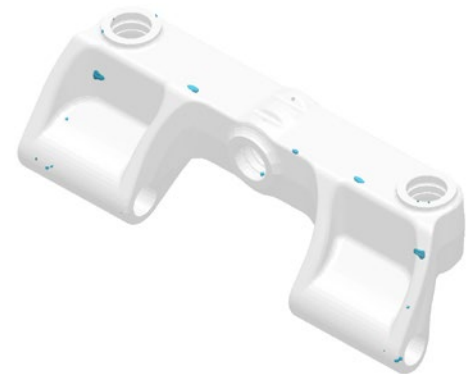
Bilden ovan visar vart programmet förutser sugningsporositeter. Genom omkonstruktionen går det sedan att göra gjutgodset mer gjutvänligt.
